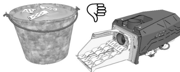
Мал.16 Недопустима робота без колосників
